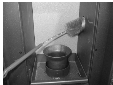
Fig. 33 - Reinigung mit Flaschenbürste
