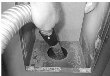
Fig. 32 - Reinigung Fach Brennschale
