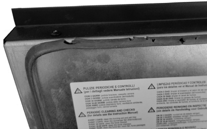
Fig. 24 - Verschlechterte Dichtung
